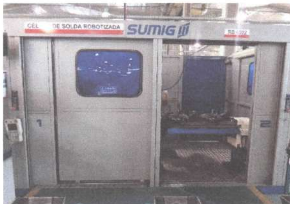
Robô FD11 para solda automática (SUMIG)
